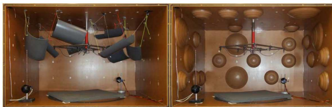
Rys. 3. Różne kształty i sposoby mocowania elementów rozpraszających dla komór pogłosowych [7]
