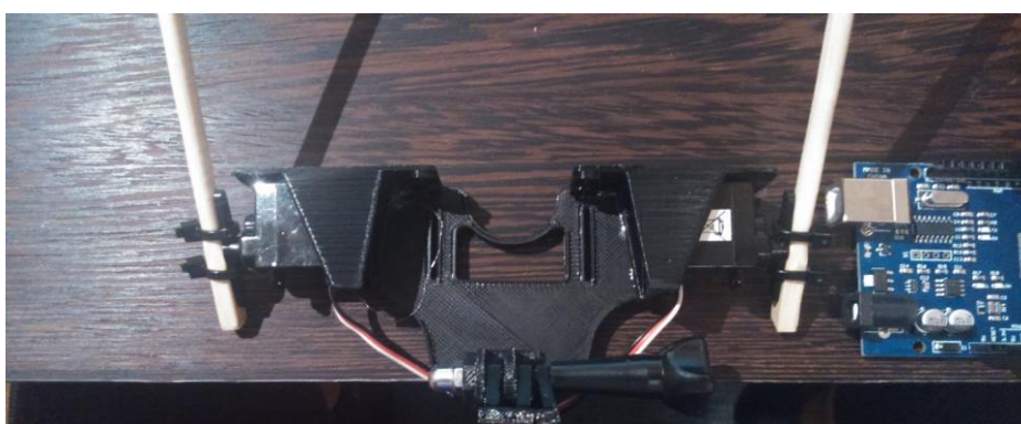
Rys.3.5 Prototyp nr 2. Konstrukcja modułarna wykonana w technologii druku 3d. Po prawej stronie zdjęcia widać mikrokontroler Arduino Mega.
