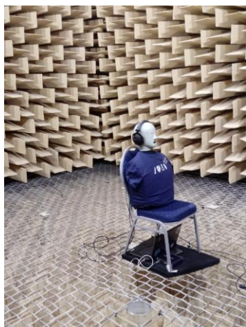
Rys. 2 Proces kalibracji sygnału za pomocą sztucznej głowy w komorze bezchowej
