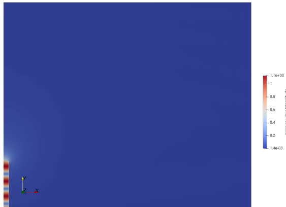
Rys. 5.9. Rozkład amplitud ciśnienia akustycznego wokół wylotu kanału wentylatora dla częstotliwości f = 474,4 Hz
