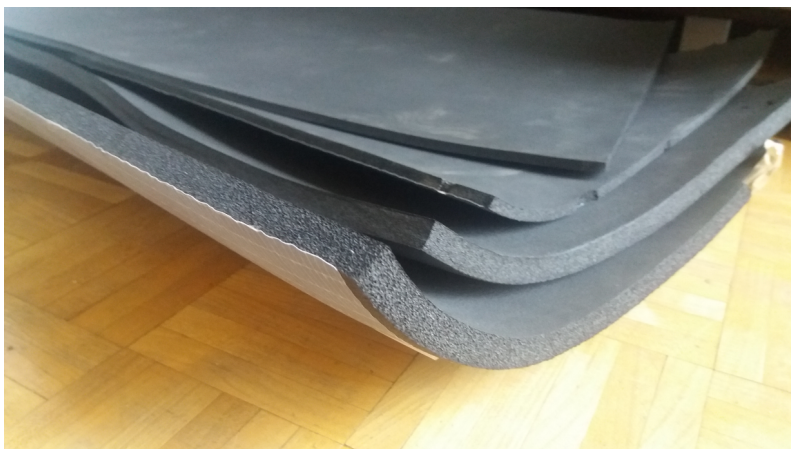
Rysunek 1. Maty kauczukowe stanowiące próbki porównawcze do badań
