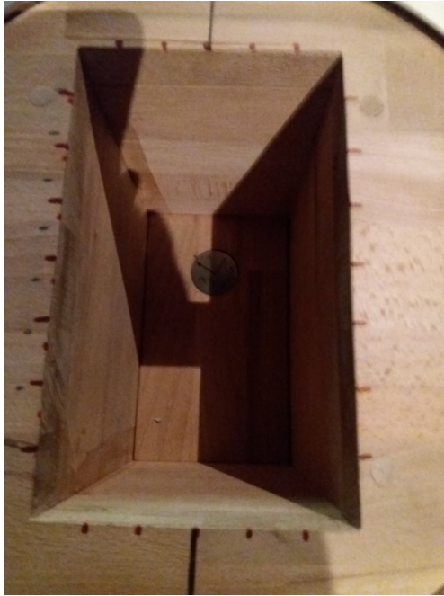
Rysunek 1. Badany obiekt wibroakustyczny: prostokątna otwarta wnęka z kołowym tłokiem umieszczonym na jej dnie
